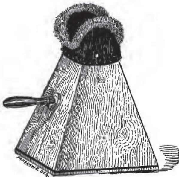
図 31. エジソンが発明した X 線透視装置 (フルオロスコープ)
