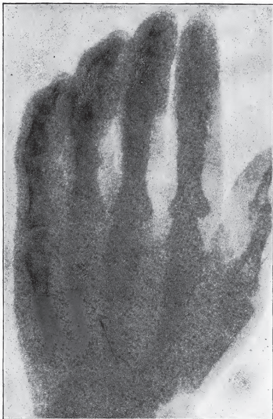
図 34. 手掌に針が刺さった手の X 線写真. トムソン二重焦点 X 線管使用. 著者撮影. 露光時間 2 分 20 秒, 距離 10 インチ. 火花長 5 インチのトムソン誘電コイル使用.
