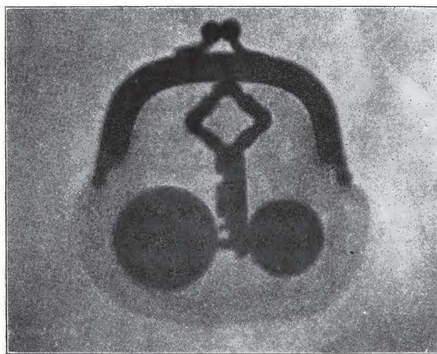
図 22b. 硬貨、鍵の入った財布の X 線写真。ウィムズハースト装置、コンデンサーなし、火花長わずか 3/8 インチで撮影 (GE 社技術部長 E. W. Rice, Jr. 氏撮影)
