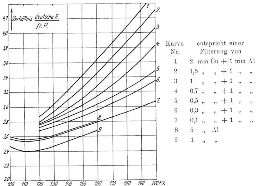
Das Verhältnis der beiden Einheiten  $\frac{\text{deutsche R}}{\text{fr. R}}$  ist eingetragen als Funktion der Spannung der Röntgenröhre (in Kilovolt) für die verschiedenen Filterungen.
